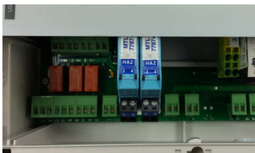
Abb. 2 Stück Zenerbarrieren in 1-Pumpen - ohne Trennplatte -
